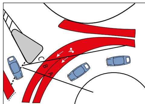
Inventé à l'étranger, ce giratoire s'avère particulièrement sûr pour les cyclistes (un accident sans gravité dans les deux ans suivant la mise en service). Ce système nous semble extrêmement intéressant dans le cas d'un grand giratoire existant (il permet de supprimer une voie). Si notre préférence s'oriente vers les petits giratoires, pour les autres cas nous demandons que ce principe soit plus étudié et testé en France.
