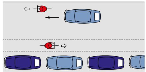
**Autre possibilité, la création d'une piste unidirectionnelle entre le stationnement et le trottoir, ceci à condition de prévoir un couloir de 2 m de large pour permettre aux cyclistes de se dépasser.**
