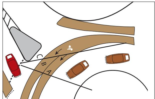
Inventé à l'étranger, ce giratoire s'avère particulièrement sûr pour les cyclistes (un accident sans gravité dans les deux ans suivant la mise en service). Ce système nous semble extrêmement intéressant dans le cas d'un grand giratoire existant (il permet de supprimer une voie). Si notre préférence s'oriente vers les petits giratoires, pour les autres cas nous demandons que ce principe soit plus étudié et testé en France.
