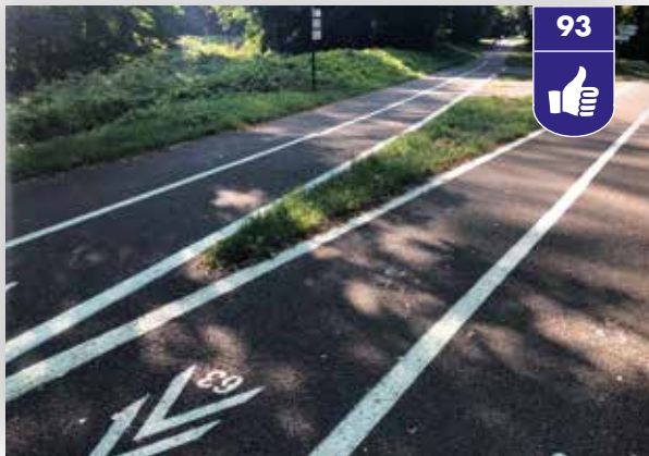
Peinture luminescente à l'essai dans le département de l'Isère.
